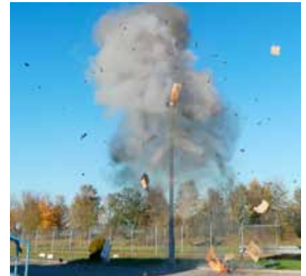
EXPLODIERENDE „GEFAHRGUT-KARTONS“. DIE TREIBLADUNG IST SCHWARZPULVER. EFFEKT-ERZEUGENDE MITTEL SIND KORK, TONMEHL, GASKARTUSCHEN UND ALKOHOL.
