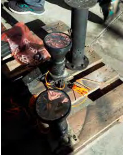
LYCOPODIUM - STARK FETTHALTIGES PULVER AUS BÄRLAPPSPOREN STECKT IN DEN GELADENEN MÖRSERN UND SORGT FÜR GEWALTIGE VERPUFFUNGEN
