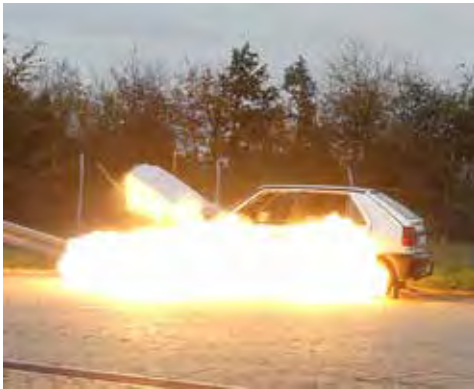
EXPLOSIONSDARSTELLUNG AN EINEM FAHRZEUG - DIE MOTORHAUBE WURDE PER STAHLSEIL AM UNKONTROLLIERBAREN HOCHFLIEGEN GEHINDERT.
