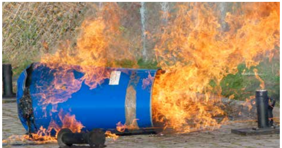
AUS DEM SCHULUNGSTEIL: "EFFEKTE MIT BRENNBAREN FLÜSSIGKEITEN" - IN DEN MÖRERN INSTALLIERTEN DIE SCHÜLER ZUVOR TREIBMITTEL, 2-KOMPONENTEN-BLITZPULVER UND DIE ELEKTRISCHE ANZÜNDVORRICHTUNG. DIE ANZÜNDUNG ERFOLGT PER FUNK.
